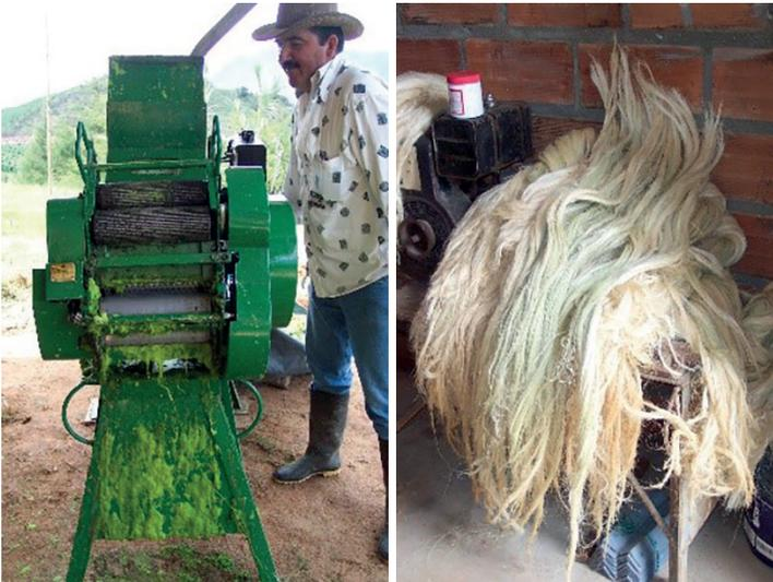
Figura 2. a) Desfibrado de la hoja de fique; b) Fibra lavada y peinada.
