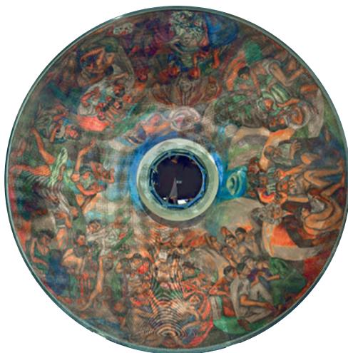
Figura 1. Imagen obtenida con escáner láser terrestre. Unión de nube de puntos de la cúpula del Aula Máxima Pedro Nel Gómez de la Facultad de Minas de la Universidad Nacional de Colombia - Sede Medellín. Fuente: Taller de Fotogrametría y Escaner Láser. IV Seminario de Representación del Proyecto, 2015. José Juan de San José Blasco y Manuel Guerrero, Universidad de Extremadura, Cáceres, España.
