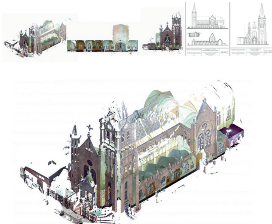
Figura 6. Imágenes obtenidas con escáner láser terrestre para trabajos de grado de Arquitectura. Fuente: herramientas fotogramétricas y escáner láser terrestre en la obtención de planimetría y propuesta de intervención urbana. Iglesia Sagrado Corazón de Jesús, Medellín, 2017. María Alejandra Escobar O.
